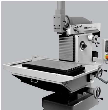
Fest installierte Spänewanne
